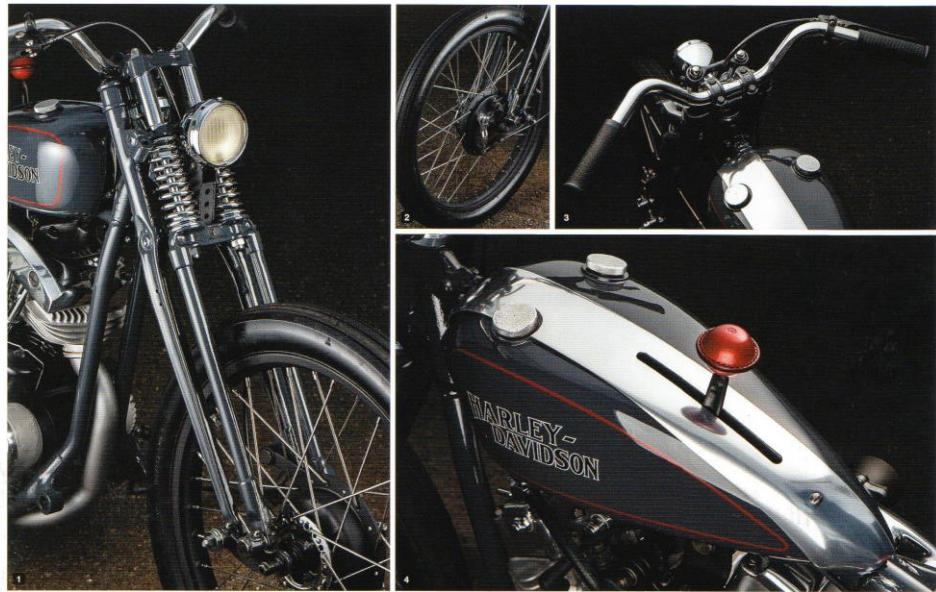
①ナローなスプリングガーフォークは、VLのリアレッグを部分的に残してワンオフで製作。さらにW&Wのガスダンパーを採用して、走行中の振動を抑えるモディファイを施している。②フォークの幅を詰めているため、フロントブレーキは国产モトクロッサーのハブドラムを流用。リムもオフ車用のアルミリムを使用して軽量化を図り、フレームまで全てセラコートでブラックアウト。③ワンオフペイントルバーをインナースロットル化。④タンクはスポーツスタータンクを7対3で分割して、その間にシフトレバーを組み込んでいる。
