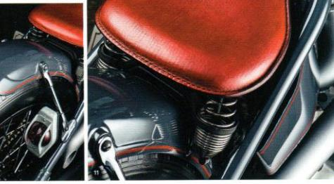
⑨クラッチを乾式化してシフトをワンオフで製作。レバーのドリルド加工など細部までぬかりない。⑩エンドが隆起したリアフェンダーは一枚のフェンダーの上にぴったりと重なり合うブレードを製作してロウ付けで仕上げている。⑪サドルシートはシートベースとスボンジの整形までショットが手がけ、レザーの着色と縫製はスタジオ ウォキニが担当。手塗りのホースハイドはムラ感があり、経年変化することを狙ったディテールだ。さらにはステーの上下で異なるピッチのスプリングを装備して様々な衝撃に対する吸収性を高めている。
