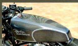
◆千葉・八街のカスタムショップ「シュアショット」が銀行スポーツスター向けに手がけたカーボン製フューエルタンクキットを換装。マシンのシルエットが激変した。
