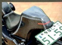
◆タンクとセットとなるシュアショットのカーボン製シートカウル。テールランプの両端にはウインカー機能も。ストラットもカットして大幅軽量化！
