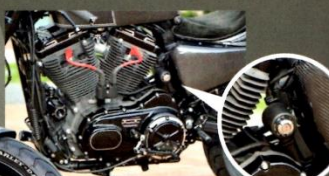
◆タンクやカウルといったボディパーツの変更により、イグニッションや配線の位置を変更することで、本来タンク前部右下にあるイグニッションが、なんとエンジン横に！
