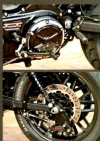
◆カフェレーサーに欠かせないバックステップは大阪の「トランプサイクル」製モデルを。さらにミスミエンジニアリング製ディスクとフレンドボ製ブレーキキャリパーという高性能パーツも備える。
