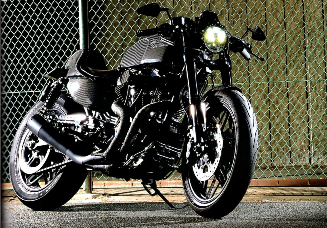
◆タンクとセットとなるシュアショットのカーボン製シートカウル。テールランプの両端にはウインカー機能も。ストラットもカットして大幅軽量化！
