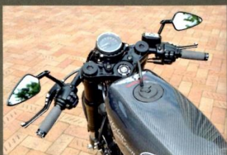
◆ロードスターのアイデンティティである43mm倒立フロントフォークに合わせ、東京・練馬のチェリースカンパニーが専用のセパレートハンドルキットを製作した。
