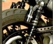
◆新しいオーリンズのリザーバータンク付き338mmブラックライン。これでも「まだ長さが足りない」と、ショック長を延長するエンドアイを加えてさらにハイポジションに。
