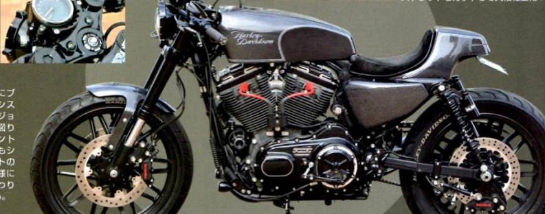
◆タンクとセットとなるシュアショットのカーボン製シートカウル。テールランプの両端にはウインカー機能も。ストラットもカットして大幅軽量化！
