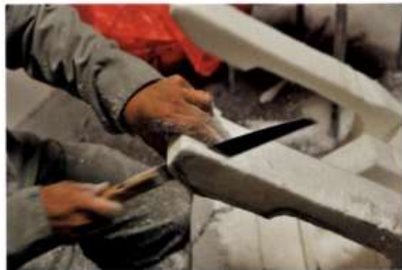
有機溶剤にも溶けない硬質ウレタンだが、意外なほど削りやすく目が均一。しかし削り粉はまるで砂のように目や口や襟元から侵入し、ビルダーを苦しめる。
