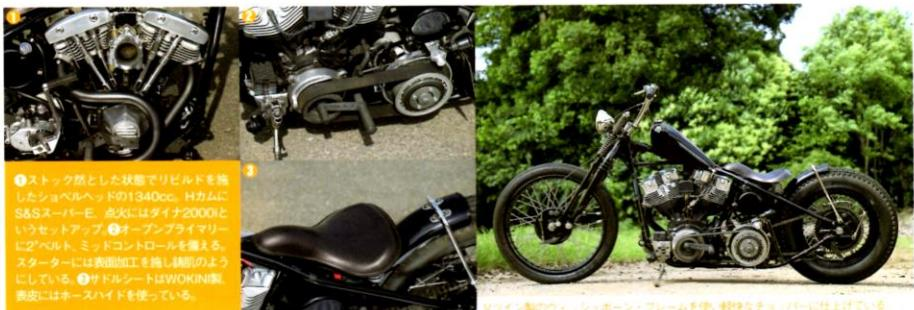
ほぼストック然とした状態を留めるようにしてリビルトされた1981年のショベルヘッド、その1340ccのエンジンをVツイン製のウイッシュボーン・リジッドに搭載したこのカスタムは、この手のスタイルに対して造詣の深い千葉県八街市のショップ、シェアショットによって手掛けられたもの。H-Dの旧車に対してビギナー然としたオーナーに合わせ、そのセットアップは上質ではあるが、敢えてカスタムとしては無難かつオーソドックスな線に抑えられたものとなっている。
