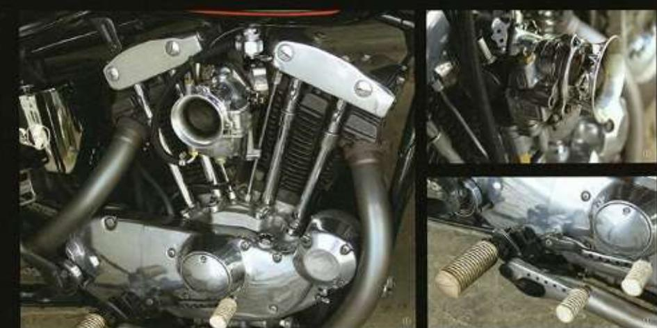
(9)ハンドルチューニングはセイドにローコンフ仕し、曲げる限りストレスがないように組み上げた 1000cc エンジン。WPC 加工した VT ピストンやサンダンス・アーマーブレーティング加工したシリコンテーなど、現代の技術を惜しみなく採用している。マフラーはワンオフ。ちなみにミスマッチだった元のクラシックカーストック部品が悪く、レブリカがないため、やっとか機器で現行の良いケースを入手して換んでいる。右 SSS スペーカーをオーバンターに、大神芦若宏園ショートファンネル。(10)左足が不自由なオーナーに合わせてショートペグをワンオフ作り。ブレーキとシフターを右側にまとめている。
