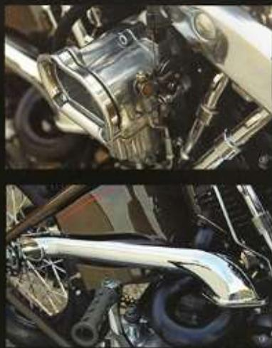
①ハンドルはクランプ式のボストが使えるようにストレートバーにし、その異なるバンドを組み合わせて製作。レバーはワンオフのトップブリッジに付いている。②スポーツスターとコフィンのデザインを合わせたワンオフタンク。ロゴはFBO STUDIO。フレームメインチャーリー下のサブフレームは鞍置式にして、水平に走り付けられるようワンオフ。タンクサイドシフターもワンオフ。③ヴィンテージのスプ
