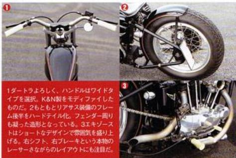
1ダートラより多く、ハンドルはワイドタイプを選択。K&N製をモディファイしたものだ。2もともとリアサス装備のフレーム後半をハードテイル化。フェンダー周りも凝った造形となっている。3エキゾーストはショートなデザインで雰囲気を盛り上げる。右シフト、右ブレーキという本物のレーサーさながらのレイアウトにも注目だ。
