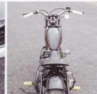
ハンドルは廃盤となった、K&N製スーパーバーの幅をカットして使用。手前がシフト、後ろがリヤブレーキ用という、わけありのセットアップになっているフットレバー。前後のホイールは純正ボラーニ・リムにパウダーコートした純正ハブ、スポークはステンレス。純正フレームはワンオフKRタイプ・ハードテールに加工している。
