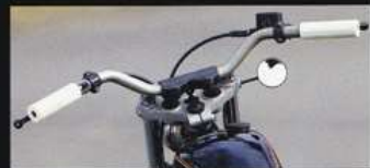
POSH製インナーズロトルでシンプルにまとめたハンドルまわり。左グリップの中になんと基礎を自作したウインカーリレーが仕込まれている。
