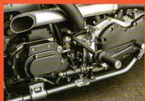
S&S 4速ケースにJIMSの5速トランスミッションをインストール。クラッチはBDLで、油圧クラッチ化。走りやすさを考慮したセディファイだ。
