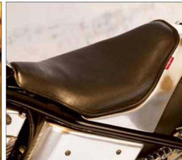
Für Highend-Customs ist der Solositz schon fast üppig bemessen, dennoch wird der Kunde aufgrund des Starrrahmens ordentlich was auf die Lendenwirbel bekommen. Unten gut zu sehen: Das Getriebe sitzt deutlich höher als der Motor
