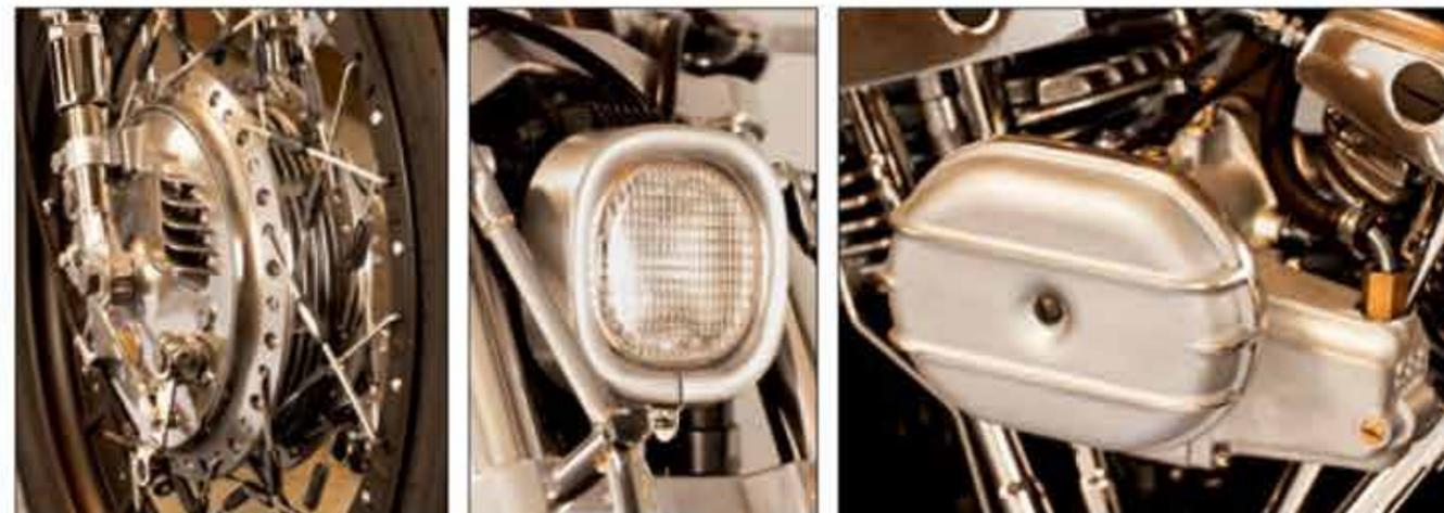
Die wunderbare Doppel-Duplex-Trommelbremse ist ein Serienteil und stammt von einer Suzuki ST400 Tempter. Die Lampenmaske und das Luftfiltergehäuse sind Eigenleistungen von Sure Shot. Großes Bild unten: Der Geberzylinder der hydraulisch betätigten Kupplung sitzt über dem Primärtrieb links neben dem Zylinderfuß des hinteren Zylinders
