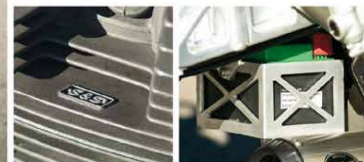
S&S bietet nicht nur Harley-Komponenten, sondern unter anderem auch ein 865-ccm-Big-Bore-Kit für Royal Enfields. Rechts: Die Skyrich-Lithium-Ionen-Batterie wiegt nur 900 Gramm – 3,5 Kilo weniger als das Blei-Säure-Pendant von Yuasa
