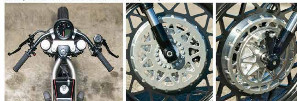
Oben links: Das Federbein sitzt hinterm Tank unter der Sitzbank. Über eine raffinierte Umlenkung beaufschlagt die Schwinge das Racing-Bros-Federbein. Unten: Die Bremsscheibe ist mittels eigens konstruierter Aluminium-Komponenten leicht abgekapselt. Sie ist mittig montiert und wird von einer kleinen Brembo-Zange verzögert
