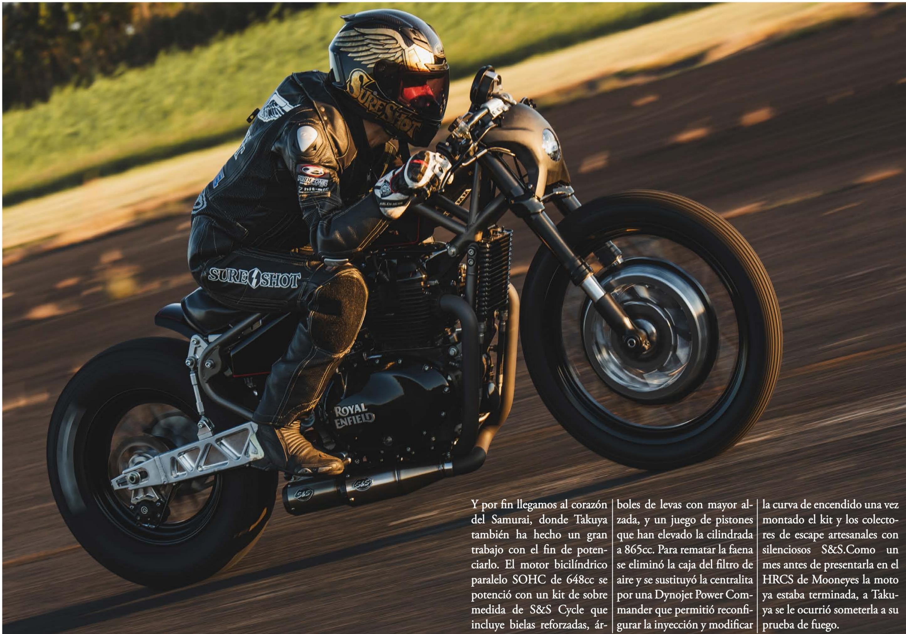
Y por fin llegamos al corazón del Samurai, donde Takuya también ha hecho un gran trabajo con el fin de potenciarlo. El motor bicilíndrico paralelo SOHC de 648cc se potenció con un kit de sobre medida de S&S Cycle que incluye bielas reforzadas, ár-
