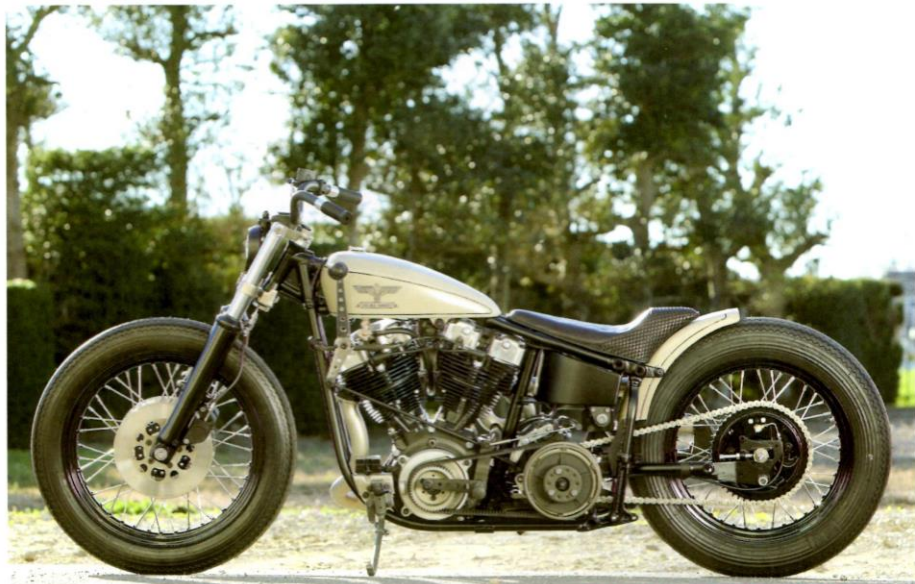
4速スイングアーム・フレームのまま、リジッドを思わせるシルエットで車体を構成。ワンオフのカンチレバー・サスを備えている。
