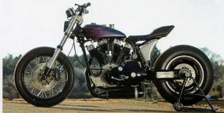
片持ちスイングアームに際してもノーマルにモディファイせず、後部ダブルブレーキのブレイドを一枚取り替えている。
