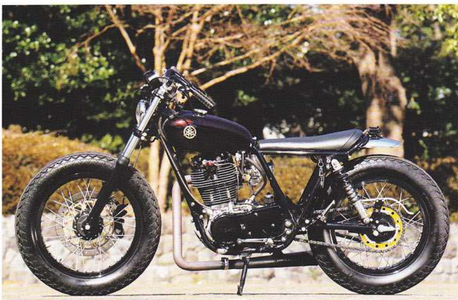
フロントブレーキにはサンスター-320mmフローティングディスクを装備。前後FKエクスルH型アルミリムで、F19、R18インチ。
