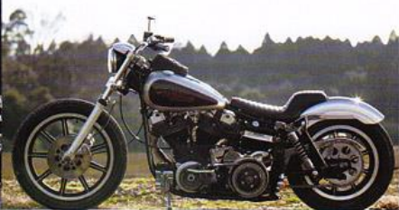
ネックシャフト加工で純正より3度起きたFフレーム。数々の隠し技が冴える一台だ。
